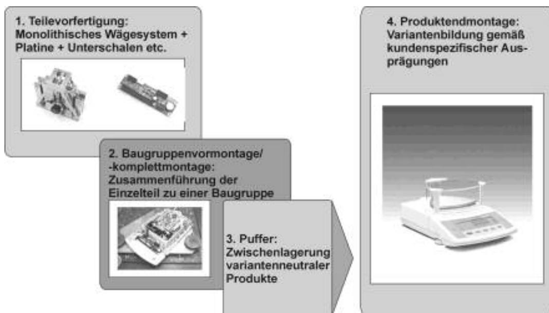
Bild 14: Der Fertigungsablauf einer Waage vom Einzelteil bis zum fertigen Produkt
