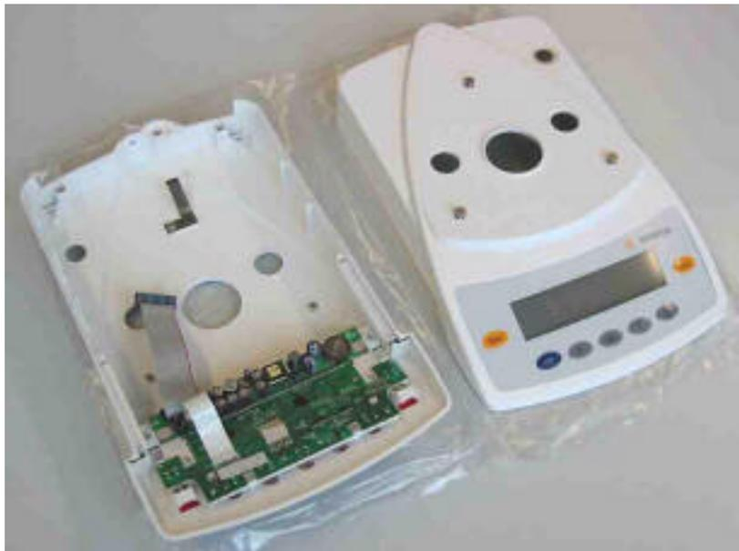
*Bild 16: Anzeigekopf und Unterschale einer Sartorius-Waage*
